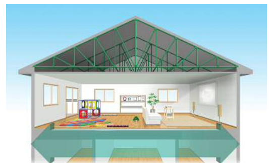
無柱化が可能な鉄骨屋根トラス
