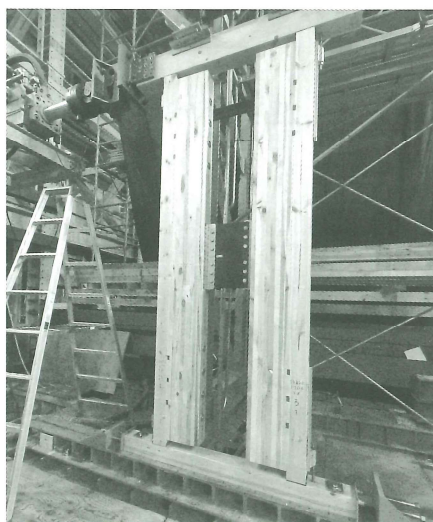
実証実験でEndure Wallを組み込んだ建物は、繰り返しの地震でも変形を小さく抑えられることを確認
