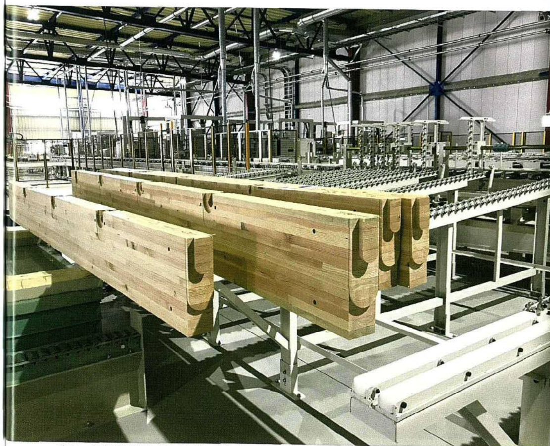
ポラテックでは、CADデータなどを基に自動で加工を行い、高い精度のプレカット材を生産している
