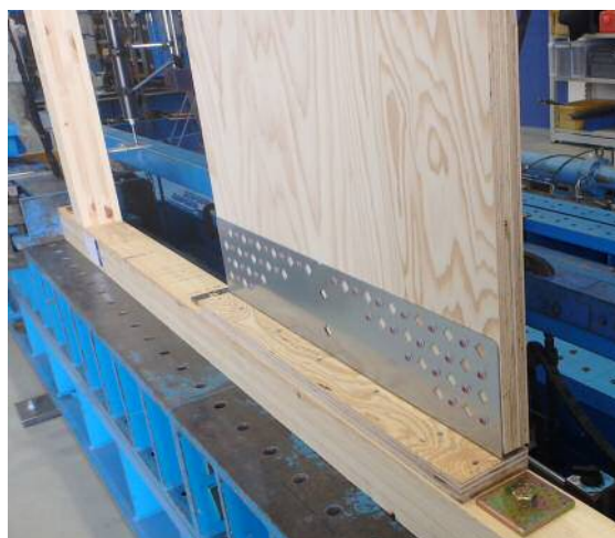
取付けは専用金物をビスにて固定
