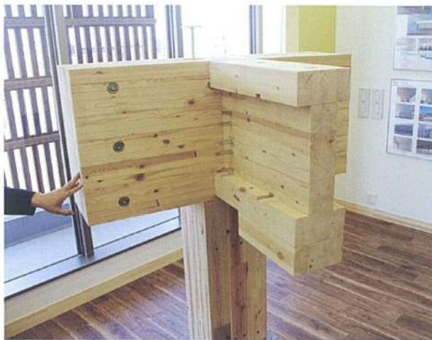
「合せ柱・合せ梁・重ね梁」の複合サンプルを展示
